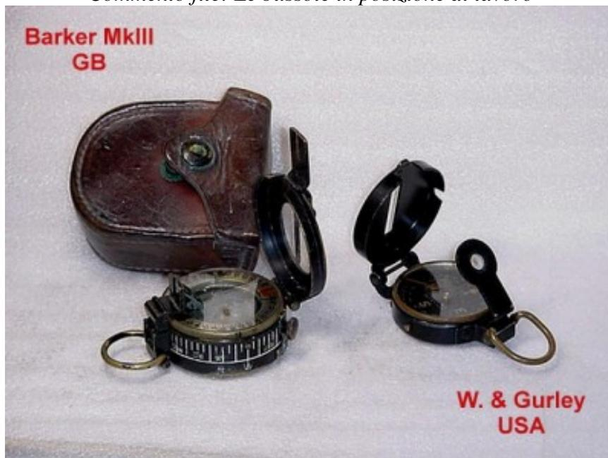
Eppure non potrebbero essere più diverse fra loro: la Gurley semplicissima e funzionale, la Barker estremamente sofisticata, impermeabile con visione prismatica otticamente regolabile, alidada di madreperla immersa in liquido, camera di compensazione per la temperatura, costruzione robustissima in ottone, precisione ai limiti del possibile.
