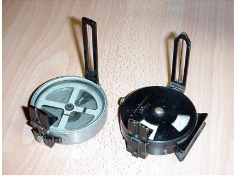
A destra vedete una bussola Barker della fine 800, ma già dotata di lettura prismatica regolabile, traguardi, clisimetro per la rilevazione della pendenza, ecc.
