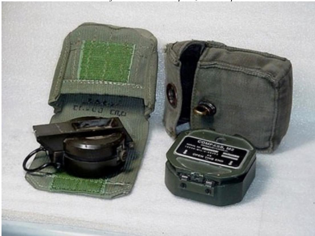
La Brunton M2 è il mostro sacro americano, il non plus ultra delle bussole, quella che ha tutto e che non deve chiedere nulla: correzione del nord magnetico, alidada di ampie dimensioni, clisimetro per la determinazione delle pendenze, smorzatori magnetici e pneumatici, compensazione verticale, linee di traguardo dalle dimensioni esagerate, ecc. ecc. ecc. ecc.
